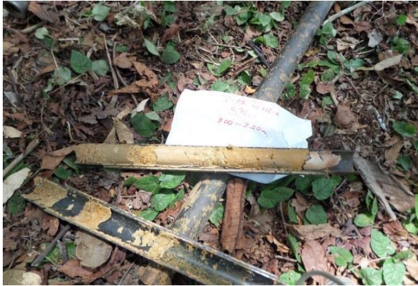
Ilustración 8. Fotografías apique 3 realizado para obtención de muestras semialterada con cuchara, avance con equipo de perforación SPT, tubería AWG, pesa, contrapesa.
