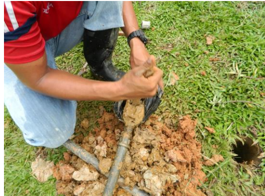
Ilustración 7. Fotografías apique 2 realizado para determinar parámetros en terreno por medio de veleta y penetró metro de bolsillo, con avance con barreno.
