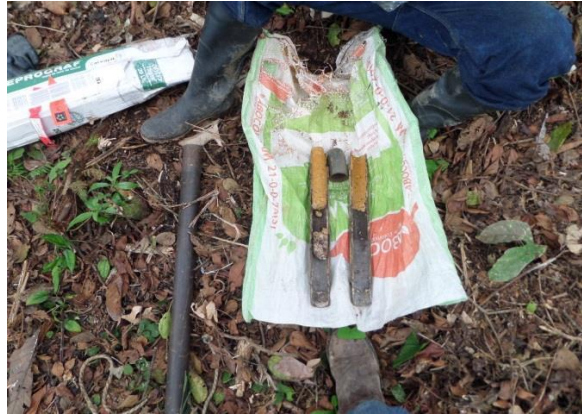
Ilustración 8. Fotografías apique 3 realizado para obtención de muestras semialterada con cuchara, avance con equipo de perforación SPT, tubería AWG, pesa, contrapesa.
